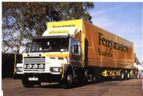
Scania T143H4x2. Sattelzugmaschine mit Pritschenaufleger.
