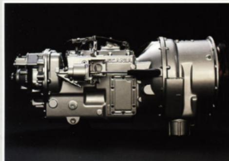
Zehngang-Range-Getriebe mit Drehmomentwandler.
