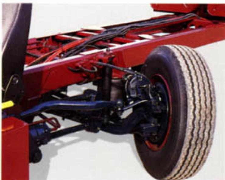
La suspensión anterior consta de dos cojines de aire, situados bajo los largueros, dos amortiguadores y barra estabilizadora. El eje está guiado por 4 robustas barras de reacción longitudinales y barra Panhard.
