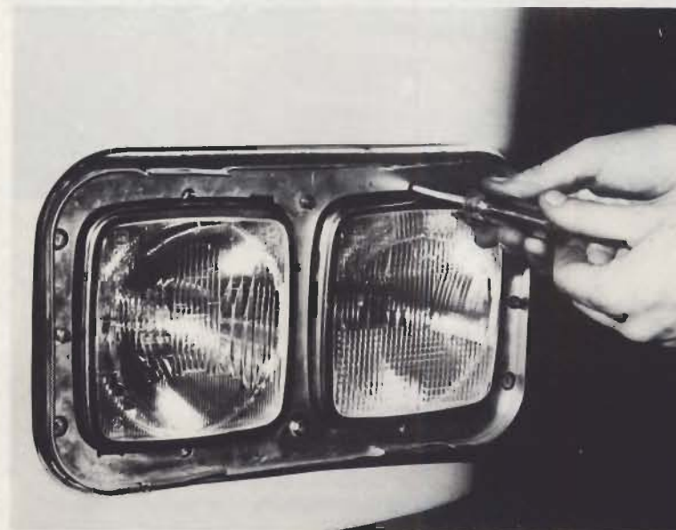
Fig. 14.2. — Tornillo de reglaje de los faros
