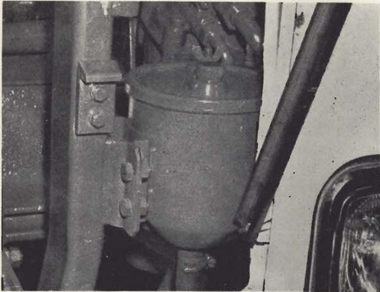
Fig. 10.5. - Situación del depósito de la servodirección
