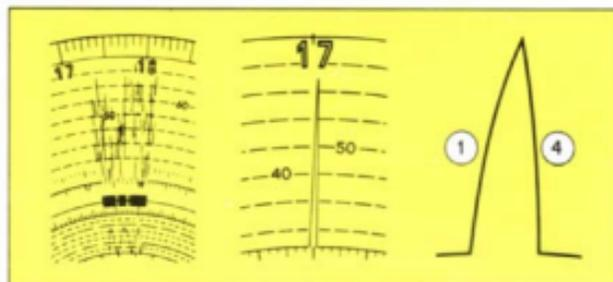
**Forma típica de conducción anti-económica:** Líneas de velocidad en forma de agujas, que denotan su aceleración rápida con fuerte frenado inmediato.
