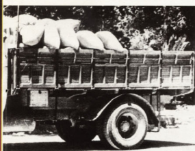
Un Hispano-Suiza 40/50 CV, con motor diésel Ganz.
