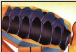
Tambor de amasado y hélices, construido en acero BARYHARD-355, altamente resistente al desgaste.
