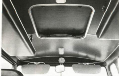
Otro detalle de la dotación interior en la que las formas sencillas son la base. El techo está recubierto con paneles plastificados, enmarcados con molduras de aluminio, lo cual le da a la vez una óptima funcionalidad de cara a los trabajos de limpieza interior. La trampilla superior de aireación es de cuatro posiciones. El reloj es eléctrico.
