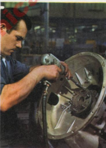
Arriba: Fase de montaje del cigüeñal sobre el cárter motor
