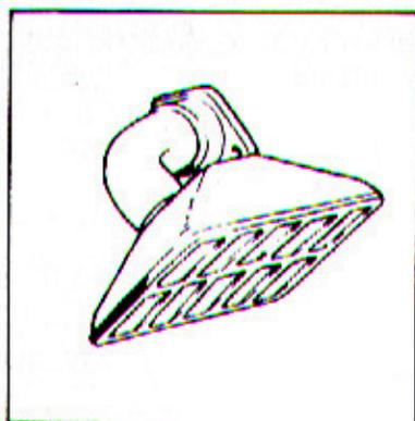
Vacíe el aceite del motor y desmonte la cubeta de aceite. Una vez efectuadas estas operaciones, extraiga la conducción de la bomba que lleva incorporado el filtro de aspiración y efectúe su limpieza.
