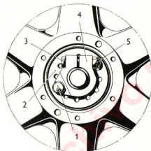
Fig. 9.2. - Disposiciones de la tuerca de frenado del eje
