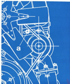
Fig. 2.11. - Tensado de las correas de mando del ventilador, bomba de agua y alternador
