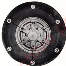
Fig. 8.1. - Orden de apriete de las tuercas de las ruedas
