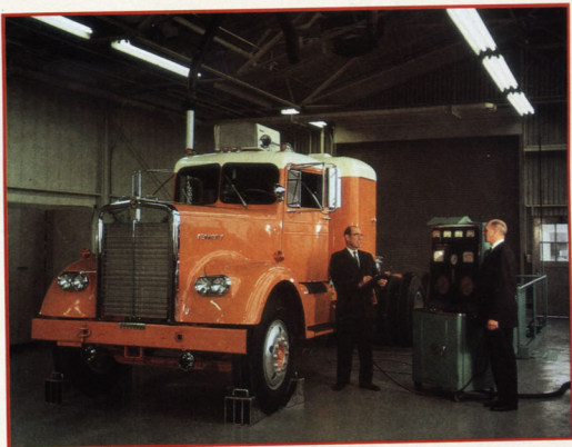
Test en banco de potencia de una tractora Kenworth, con «sleeper», del año 58.
