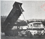
SEMIRREMOLQUE VOLQUETE CON CAJA TIPO "BAÑERA". MÍNIMA TASA DE CAPACIDAD 17 M. CUBICOS CON CILINDRO ELEVADOR CENTRAL Y ESTABILIZADOR DE TIJERA. CARGA ÚTL. 24.900 KGS.
