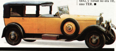
Hispano Suiza H6B Coupé, de 1927. Los faros llevaban un sistema que permitía inclinarlos.
